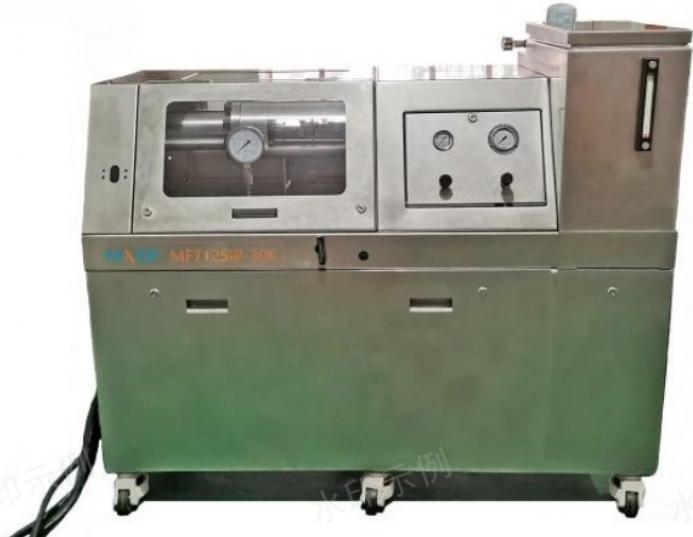
主要用于生物技术领域组织分散、医药领域样品准备、食品工业酶处理，食品中农药残留以及兽药残留检测以及在制药工业、化妆品工业、油漆工业等方面。均质机采用不锈钢系统，可有效分离护体样品表面和被包含在内的微生物均一样品，样品装在一次性无菌均质袋中，不与仪器接触，满足快速、结果准确、重复性好的要求。主要用于生物技术领域组织分散、医药领域样品准备、食品工业酶处理，食品中农药残留以及兽药残留检测以及在制药工业、化妆品工业、油漆工业等方面。均质机采用不锈钢系统，可有效分离护体样品表面和被包含在内的微生物均一样品，样品装在一次性无菌均质袋中，不与仪器接触，满足快速、结果准确、重复性好的要求。均质机特点：运转稳定、噪音小、清洗方便、机动灵活，可连续使用，对物料可进行超细分散、乳化。可适用于工业生产的乳化、均质和分散。能使料液在挤压。强冲击与失压膨胀的三重作用下使料质细化混合。本设备是食品。乳品。饮料等工业的重要设备。对牛奶豆乳等各类乳品饮料，在高压下进行均质，能使乳品液中的脂肪球细化，使其制品食用后易于消化吸收，提高使用价值。
